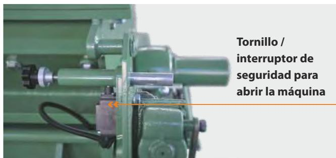
Tornillo / interruptor de seguridad para abrir la máquina
